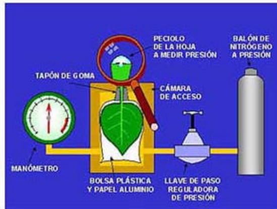
Figura 1. Esquema de la cámara de presión.
