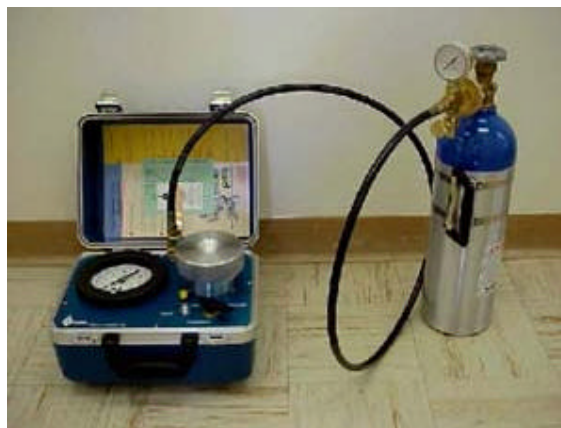
Foto1. Cámara de presión.
